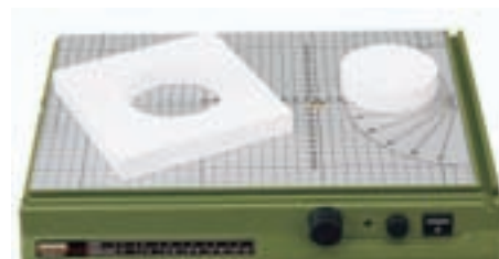
Taierea cercurilor si a arcelor de cerc se poate face foarte simplu: se fixeaza o pionsa pe masa aparatului cu ajutorul unei benzi adezive, acesta servind ca centru.
